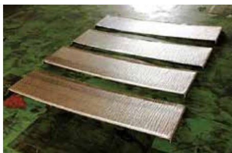
図1. フランジ部まで断熱材を貼付けた鋼板
