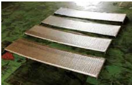
図1. フランジ部まで断熱材を貼付けた鋼板
