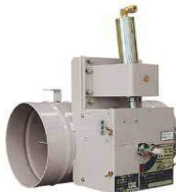
・シリンダー内スプリングの力によりダンパー開状態を保ち、非常時はガス加圧及び温度ヒューズの溶断により自動閉鎖
