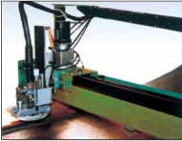
▲ (RN後) X軸、Y軸サーボモーター
