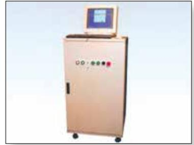
▲ (RN後) NC制御盤、NCドライブ、
